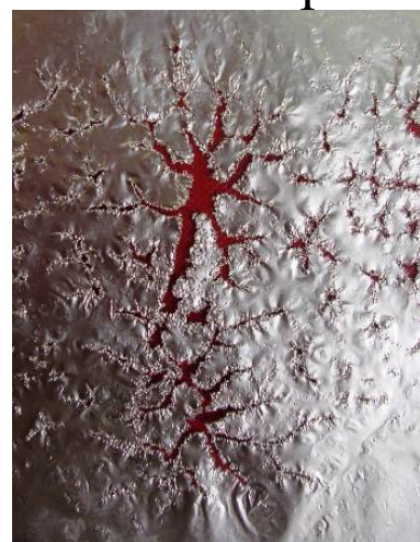
Результаты разрушения тестовых образцов фольги в трубчатом вибраторе при различных уровнях звукового давления
