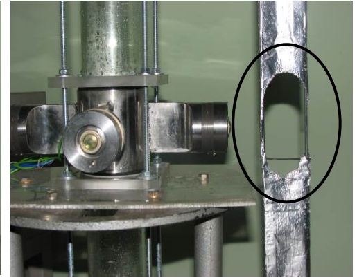
Область кавитационного разрушения
