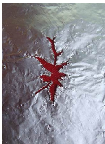
Результаты разрушения тестовых образцов фольги в трубчатом вибраторе при различных уровнях звукового давления
