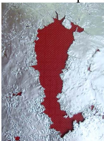
Результаты разрушения тестовых образцов фольги в трубчатом вибраторе при различных уровнях звукового давления
